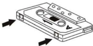
**Opmerking:** Zorg ervoor dat het wispre-ventielipje aan de bovenzijde van de cassette niet verwijderd is. Als deze lipjes verwijderd zijn, kan de cassette niet voor opname gebruikt worden
