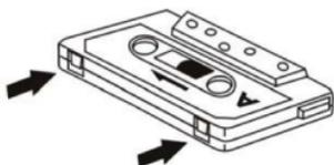
**Hinweis:** Sicherstellen, dass der Überschreibungsschutz an der Oberseite der Kassette noch nicht entfernt wurde. Sofern der Schutz bereits entfernt wurde, kann diese Kassette nicht für Aufnahmen verwendet werden.
